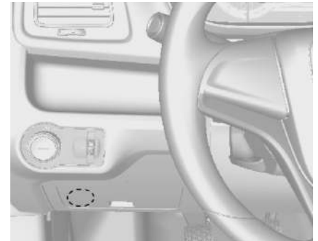
Блок предохранителей в приборной панели
